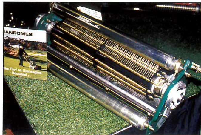
Neue Vertikutier-Einheit mit Federzinken, „Early Spring Brush“ (Ransomes)
